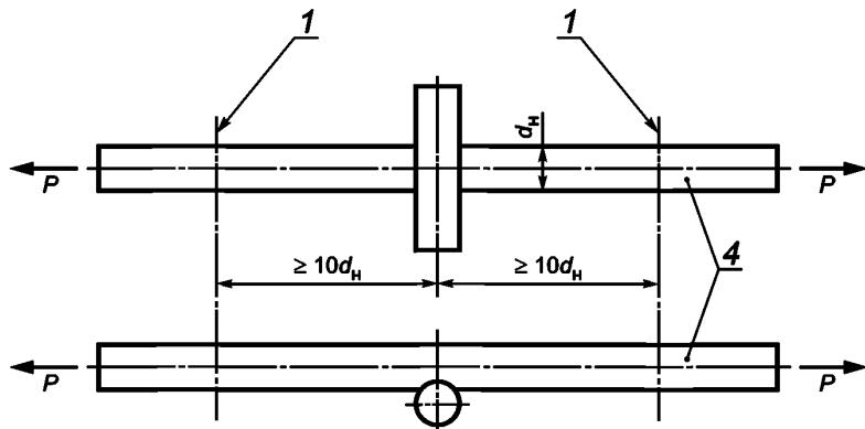
$d_H$  — номинальный диаметр рабочей арматуры;  $P$  — испытательная нагрузка;
