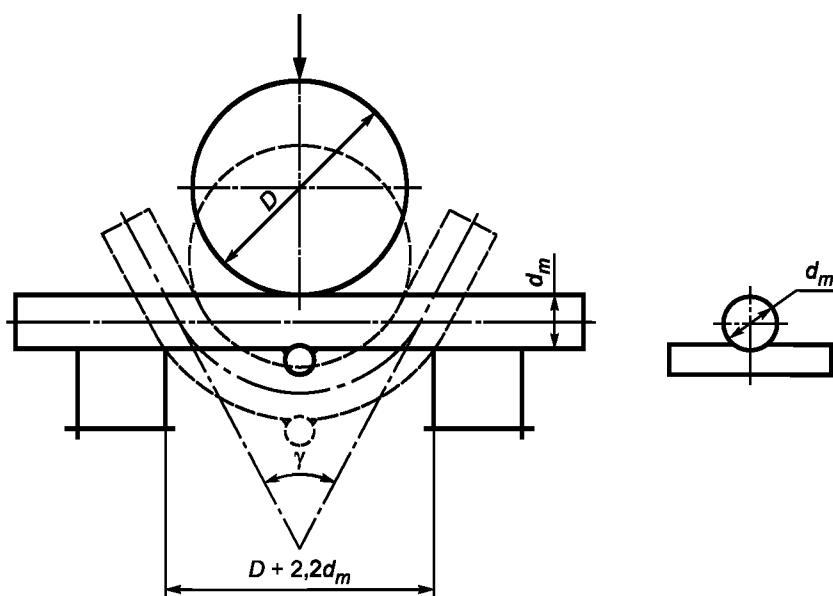
$D$  — диаметр оправки;  $d_m$  — максимальный размер поперечного сечения испытуемого арматурного проката;
