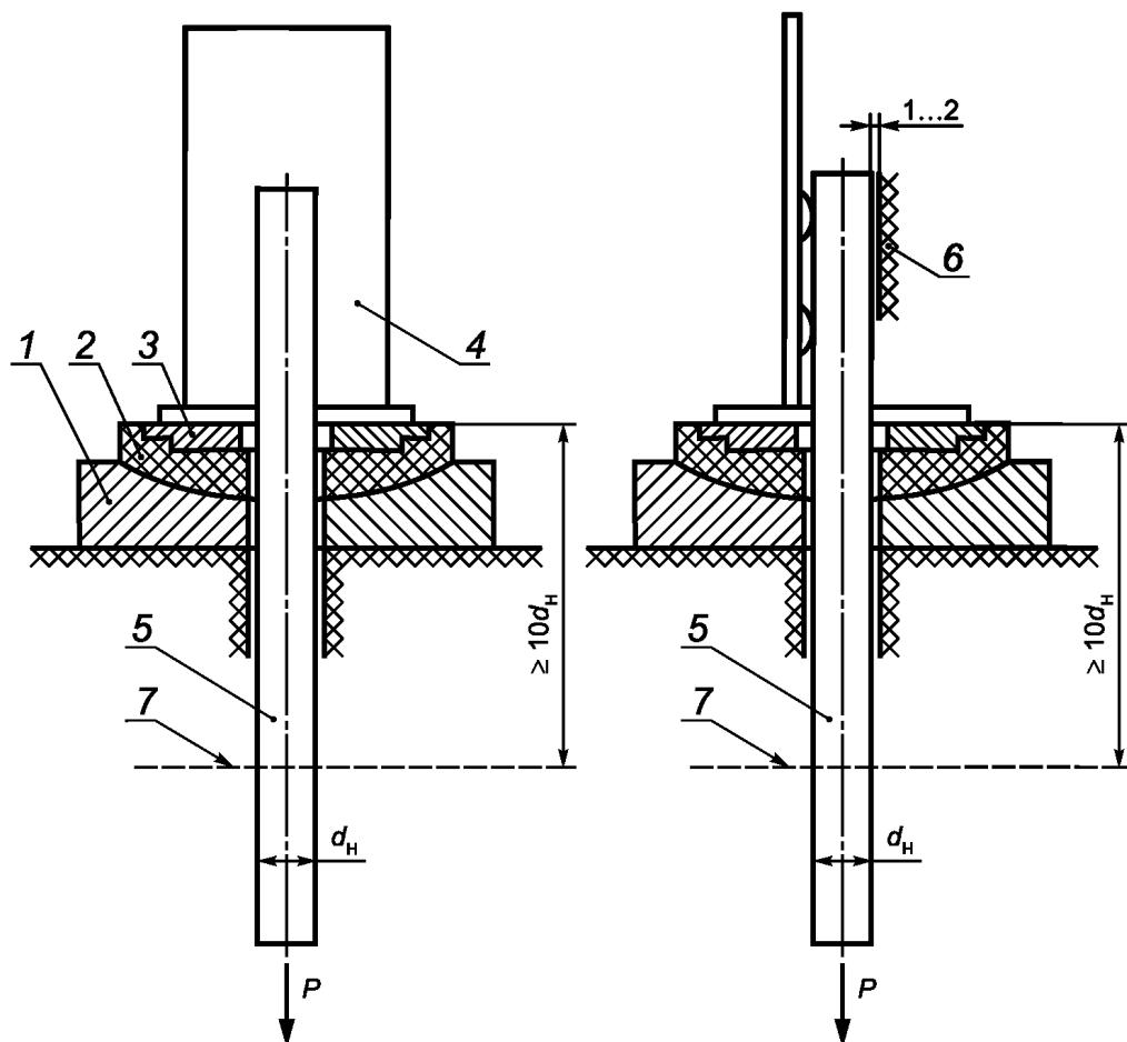
$d_h$  — номинальный диаметр анкерного стержня;  $P$  — испытательная нагрузка; 1 — сферическая опора; 2 — сферический вкладыш; 3 — сменное опорное кольцо; 4 — плоский элемент закладного изделия; 5 — анкерный стержень; 6 — упор, препятствующий изгибу образца; 7 — граница закрепления в захватах разрывной машины
