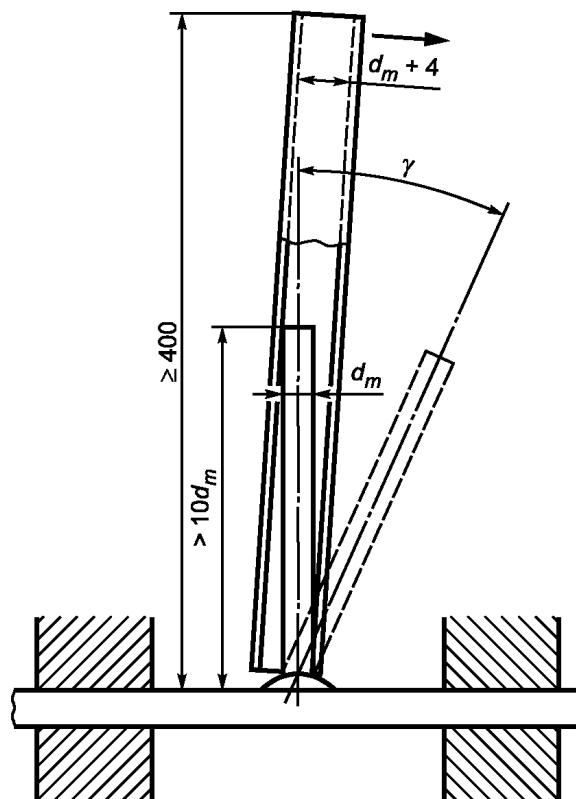
$d_h$  — номинальный диаметр испытуемого арматурного проката;  $d_m$  — максимальный размер поперечного сечения испытуемого арматурного проката;  $\gamma$  — угол загиба испытуемого арматурного проката
