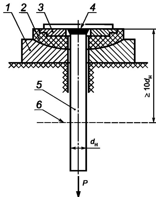
$d_h$  — номинальный диаметр анкерного стержня;  $P$  — испытательная нагрузка; 1 — сферическая опора; 2 — сферический вкладыш; 3 — сменное опорное кольцо; 4 — плоский элемент закладного изделия; 5 — анкерный стержень; 6 — граница закрепления в захвате разрывной машины
