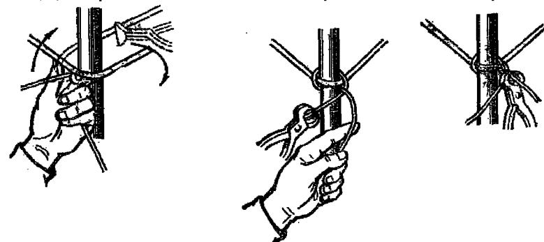
б) Вязка угловых узлов
